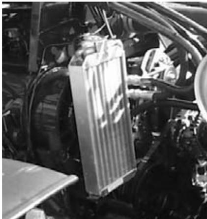
Le nettoyage peut s'effectuer avec un jet d'air comprimé et, si nécessaire, aussi avec un jet de vapeur (6 bars maximum) ou d'eau. Parallèlement, si vous procédez au nettoyage du moteur, veillez à protéger le filtre à air, l'alternateur et le démarreur. Après que vous ayez remis en place les parties déposées au préalable, mettez en route le moteur et laissez tourner pendant quelques minutes pour permettre aux pièces (parties ou organes) de sécher en chauffant.
