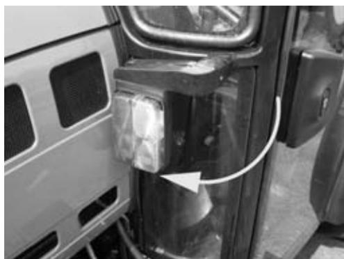
Dans les travaux ou la présence de végétation peut créer des obstacles, le support des feux peut être tourné vers l'intérieur (comme représenté sur la figure ci-contre) pour éviter, par exemple, que des branches se prennent dans celui-ci.
