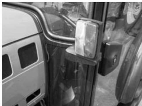
Pour les tracteurs équipés d'une cabine, les feux de position avant situés sur l'aile sont fixés à un support mobile. Ce support doit être positionné comme le montre la figure ci-contre en circulation routière.
