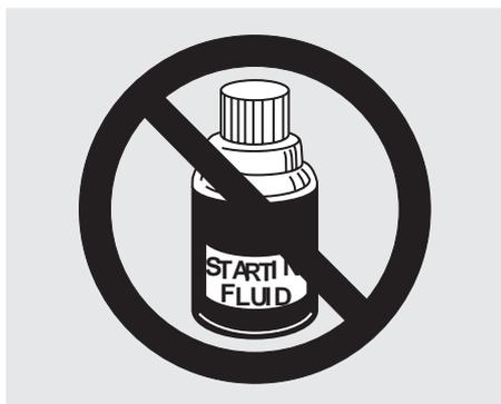
Manipulez le fluide de démarrage selon les instructions du fabricant. Un tel produit ne doit être utilisé que lorsqu'un système de démarrage à l'éther a été installé d'origine par le constructeur ou sous forme d'accessoire par le revendeur. Sur les tracteurs équipés de bougies de préchauffage ou de thermostarter, ces derniers doivent être retirés avant l'installation du système de démarrage à l'éther.
