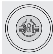
**N.B.** - Il ne faut absolument pas utiliser le blocage des différentiels lorsqu'une roue patine excessivement. Si cela se produit, appuyer sur la pédale d'embrayage avant de bloquer les différentiels.
